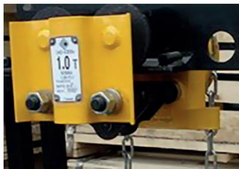
Техническое обслуживание кошек ручных 1,0А и 1,0Б заключается в проверке качества затяжки гаек на оси и внешнем осмотре узла подвески тали. При ослаблении затяжки гайки подтянуть.
