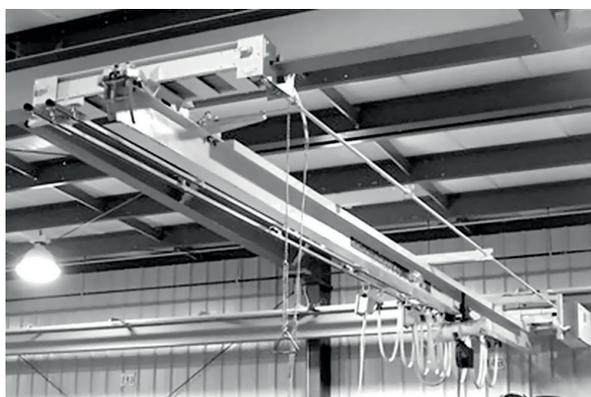
Устройство мостового крана отличается удивительной простотой, но при этом простота в конструкции крана является, отнюдь, не его недостатком, а основным достоинством. Конструкция мостового крана заключается в том, что его главная направляющая балка соединяется с двумя поперечными балками, по которым он и перемещается, всего может быть
